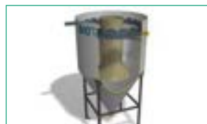
Decantador de lodos troncocónico
