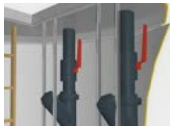
Válvulas de corte y antirretorno.
